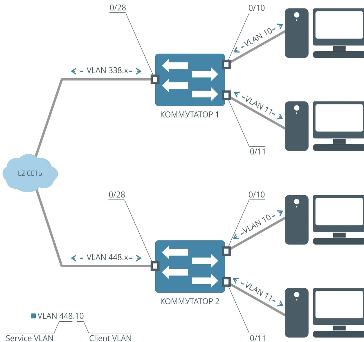
Данное поведение можно реализовать с помощью назначения UNI и NNI интерфейсов. В нашем примере NNI-интерфейсами будет интерфейс 0/28, UNI-интерфейсами будут 0/10, 0/11, 0/12 и другие интерфейсы коммутаторов, которые ведут к клиентам. Вне зависимости от того, есть ли у пакета VLAN, UNI-интерфейс добавляет тег S-VLAN. NNI-интерфейс принимает пакет с двойным тегом и передает его согласно L2 таблице и правилам участия VLAN на NNI- и UNI-интерфейсах.
