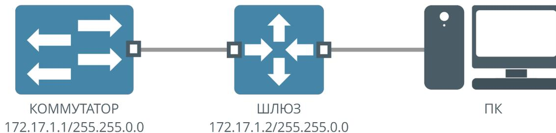
Для подключения ПК к коммутатору через шлюз необходимо настроить адрес шлюза на коммутаторе, а также настроить маршрутизацию в сеть коммутатора со стороны ПК (на шлюзе или на ПК, в зависимости от настроек сети).
