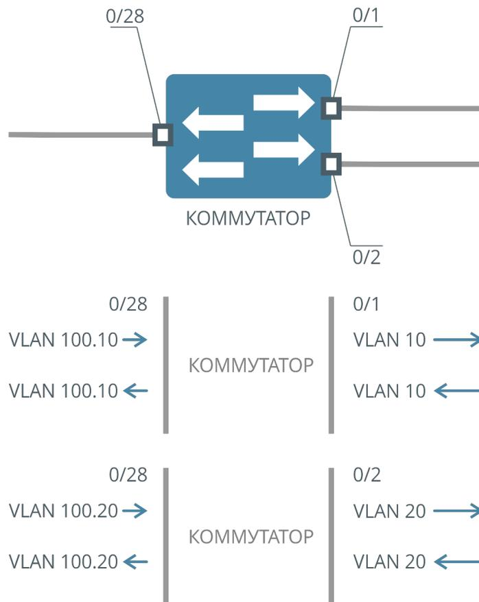
За интерфейсом 0/28 расположена сеть провайдера, где должны проходить пакеты с двойным тегом, значит интерфейс 0/28 будет NNI-интерфейсом, остальные UNI-интерфейсами. После назначения первого NNI-интерфейса, остальные интерфейсы автоматически станут UNI-интерфейсами.
