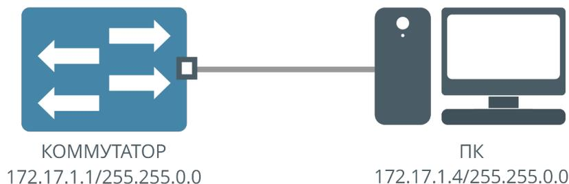
На схеме указан адрес коммутатора по умолчанию. При таком соединении и настройке доступность коммутатора с ПК можно проверить командой ping:
