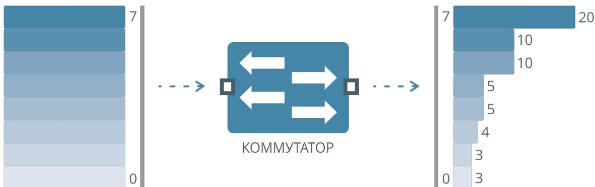
Алгоритм настраивается применительно к отдельной очереди — допустимо настроить часть очередей с алгоритмом SP и часть — с алгоритмом WRR. На схеме ниже на очередях с 7 по 4 настроен алгоритм SP, на очередях с 3 по 0 — алгоритм WRR):
