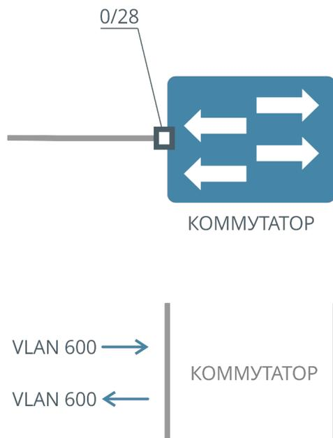
Создаем VLAN 600, указываем VLAN 600 как управляющий, настраиваем правила участия на uplink-интерфейсе.
