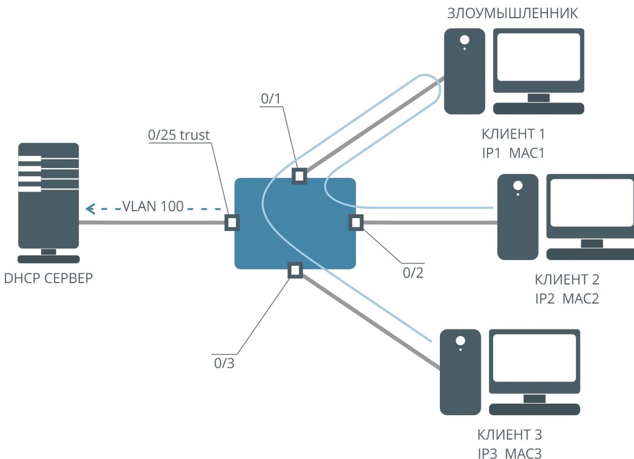
На рисунке изображен коммутатор, к которому через интерфейсы 0/1, 0/2 и 0/3 подключены клиенты. Эти клиенты получают сетевые настройки от DHCP-сервера, подключенного к интерфейсу 0/25.
