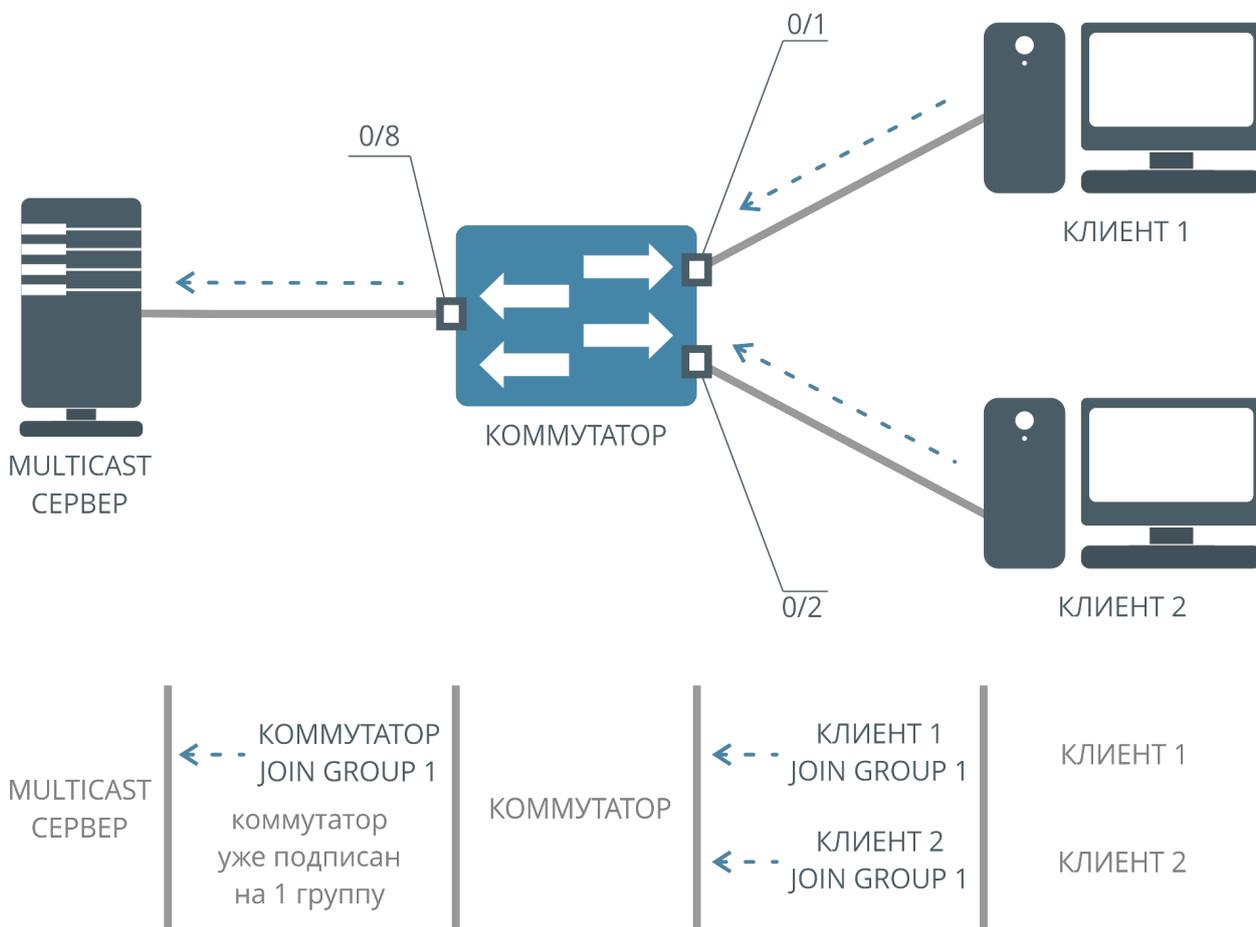
При получении IGMP Leave от клиента коммутатор отключает пересылку Multicast-трафика клиенту (сразу же или спустя некоторое время, в зависимости от режима Fast Leave на интерфейсе клиента). Отправка IGMP Leave на сервер от лица коммутатора будет произведена только в том случае, если ни один из клиентов не подписан на этот канал.
