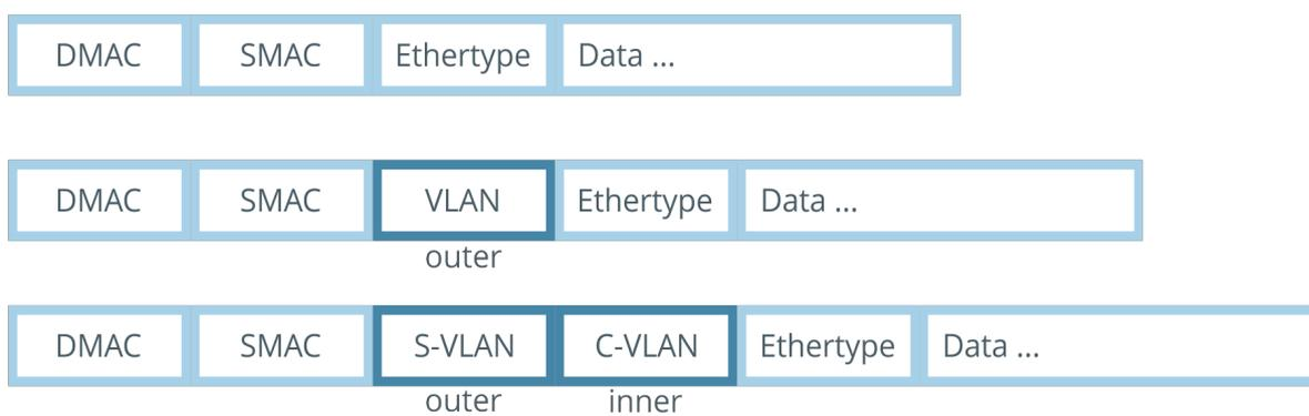
Устройства, не поддерживающие технологию Q-in-Q, обрабатывают трафик с двойным тегом по внешнему тегу (S-VLAN на схеме).
