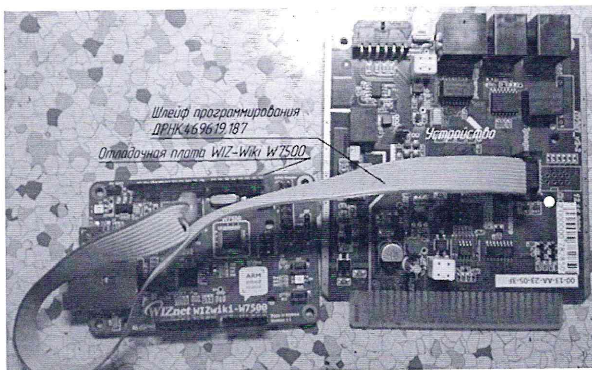
Рисунок 4. Корректное подключение устройства к отладочной плате WIZ-Wiki W7500.
