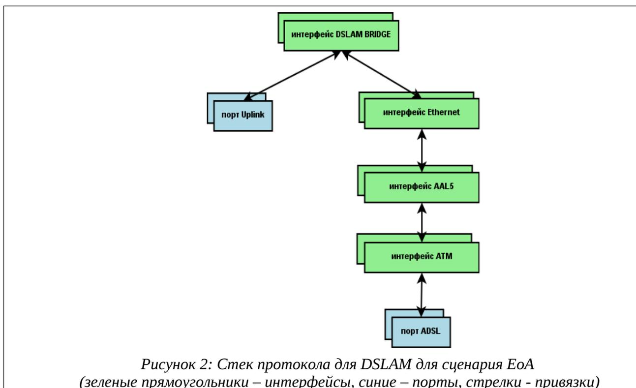
Сценарий EoA (Ethernet over ATM) – способ соединения интерфейсов в стек таким образом, чтобы пакет, принимающийся с ADSL порта, воспринимается как ATM ячейки. Интерфейс AAL5 собирает ячейки с нужными полями VPI/VCI и собирает из ячеек AAL5 кадры. Эти кадры проверяются и из них выделяются ETHERNET кадры (путем отделения
