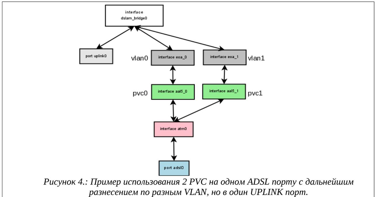
Данная схема отличается от предыдущей тем, что здесь оба AAL5 интерфейса привязаны к одному и тому же интерфейсу ATM, а через него и к одному интерфейсу ADSL. Вопрос, как определить, какая ATM ячейка куда должна пойти, определяется по заголовку ATM, а именно по полям PVC – VPI/VCI.
