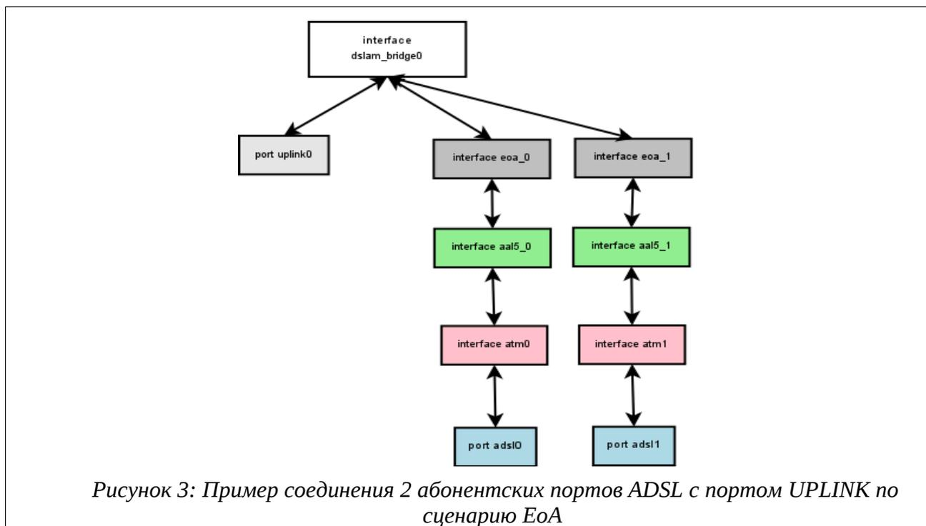
Как видно из представленной схемы, у портов только один общий интерфейс – DSLAM\_BRIDGE. Это означает, что любой экземпляр интерфейса DSLAM\_BRIDGE должен
