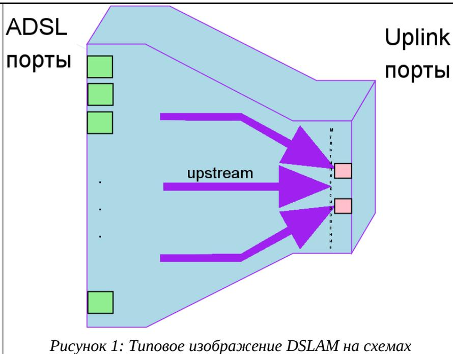
Рисунок 1: Типовое изображение DSLAM на схемах
