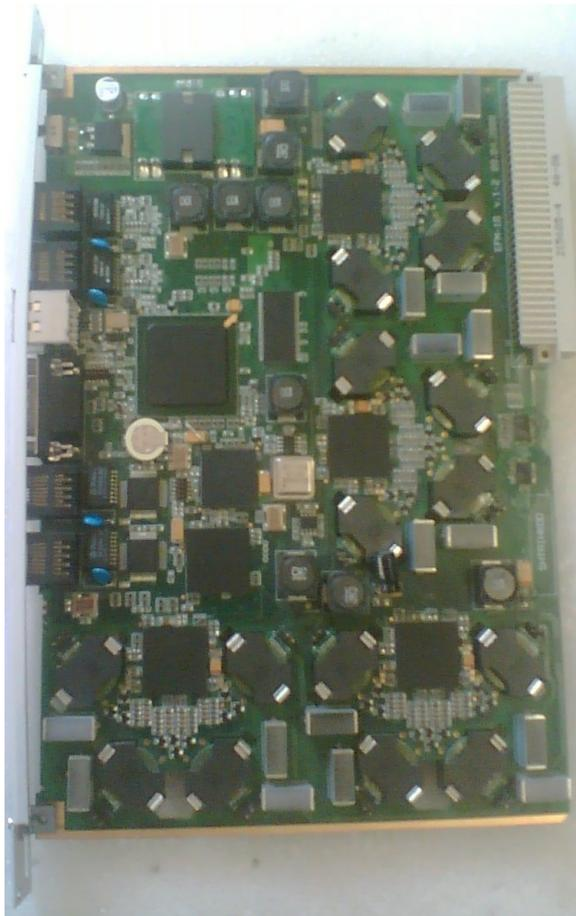
Рисунок 2: Вид платы SHDSL-16.EFM
