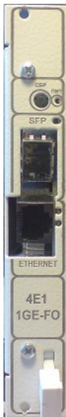
**Рисунок 1. Вид передней панели платы мультиплексор 4E1-1GE-FO**
